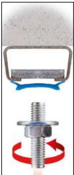
Extraer el espárrago previamente fijado.
