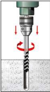
Taladrar con broca de 8 mm.
