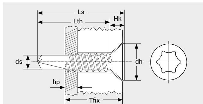
$d_s$ : Diámetro tornillo     $L_{th}$ : Parte roscada.     $H_k$ : Altura de cabeza.
