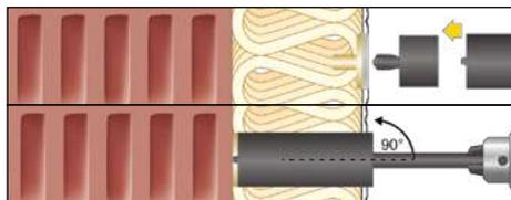
1. Coloque la guía en la broca de un destornillador (sin impacto) a través del material aislante a la pared de ladrillo hueco (quitar la guía de la perforación después de los primeros 10 milímetros).
