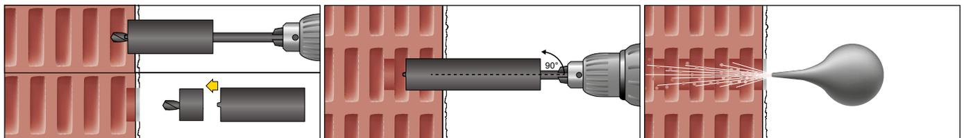
1. Coloque la corona de perforación; taladre con un destornillador inalámbrico (sin impacto) en la pared de ladrillo hueco; Retirar la ayuda para taladrar tras los primeros 10 mm.
