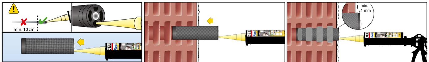
4. Presione ResiTHERM® S en la boquilla mezcladora.
