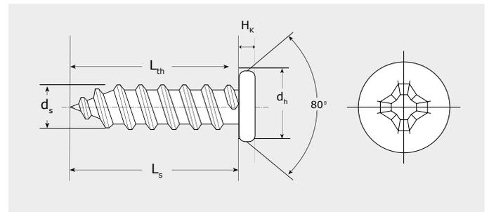
d<sub>s</sub>: Diámetro tornillo L<sub>th</sub>: Parte roscada H<sub>k</sub>: Altura de cabeza.
