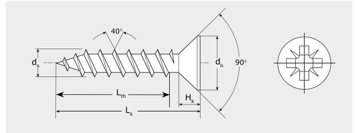
$d_s$  : Diámetro tornillo     $L_{th}$  : Parte roscada.     $H_k$  : Altura de cabeza.
