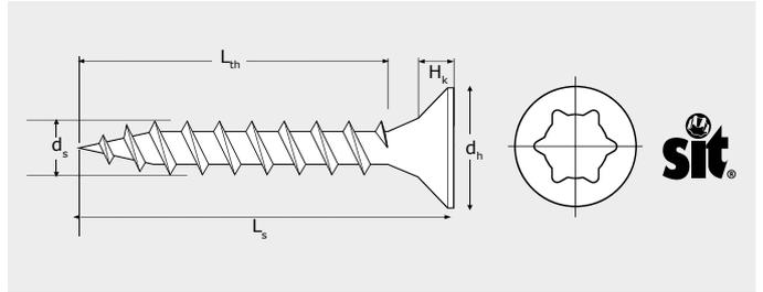
$d_s$ : Diámetro tornillo     $L_{th}$ : Parte roscada.     $H_k$ : Altura de cabeza.
