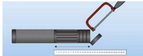
2. Medir el espesor del aislamiento y cortar ResiTHERM® si es necesario (máx. 40 mm).
