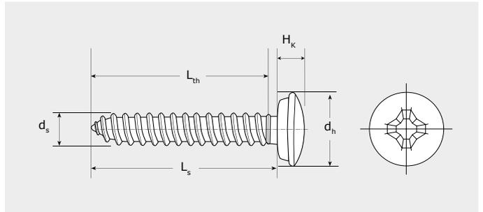
d<sub>s</sub> : Diámetro tornillo    L<sub>th</sub>: Parte roscada.    H<sub>k</sub>: Altura de cabeza.
