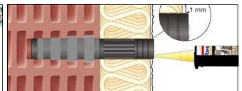
9. Coloque la fijación  $T_{inst} \leq 20$  Nm.
