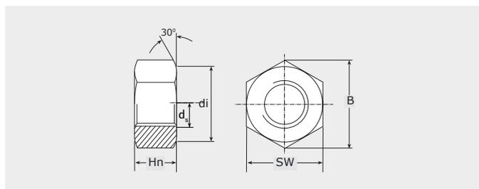
D<sub>s</sub>: Diámetro tornillo      B: Ancho
