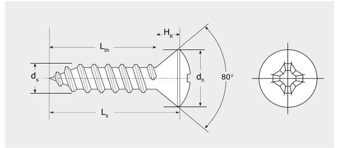
$d_s$ : Diámetro tornillo       $L_{th}$ : Parte roscada.       $H_k$ : Altura de cabeza.
