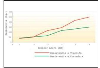
Resistencia a la tracción y cortadura según el groeso de chapa (Kg). Los valores ya llevan incorporado el coef. de seguridad figurando directamente las cargas de trabajo.
