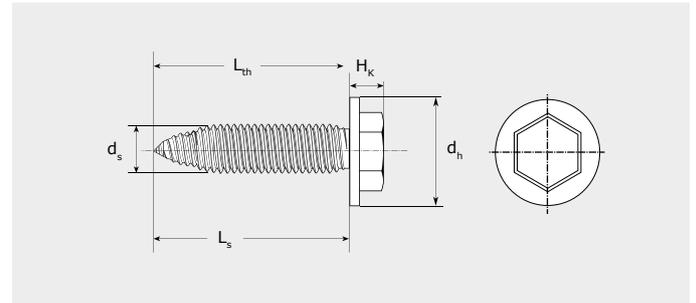
$d_s$ : Diámetro tornillo     $L_{th}$ : Parte roscada.     $H_k$ : Altura de cabeza.
